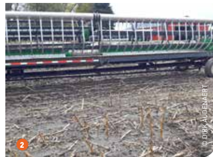
1 Die meisten Maschinen bleiben den Winter über im Freien. Ein Geräteschuppen ist laut Lohnunternehmer Ben zu teuer. 2 Das Gebiss dieses Sojaernters ist mit Druckluftschläuchen ausgerüstet, um die Bohnen von den Schoten zu trennen.
