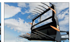
Silograb • Breite: 130 bis 250 cm • Enge Abstände der Zinken für minimalen Verlust
