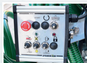
Automat-Steuerung mit Bedieneinheit in der Kabine
