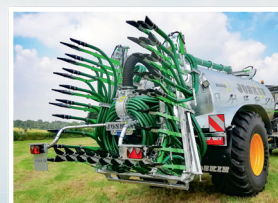
• BASIC: hydraulische Klappung (in 3 Teilen) • START: doppelte Klappung (in 5 Teilen)
