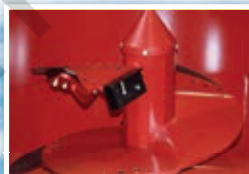
Doppelmagnetsystem an der Mischschnecke
