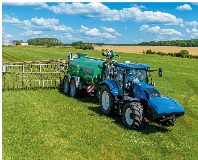
Der optionale Fronttank (270 Liter) erhöht die Autonomie des Traktors erheblich. In Zukunft soll eine Version mit abbaubarem Zusatztank angeboten werden.
